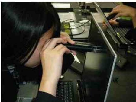
PCの画面を30倍簡易顕微鏡で観察する。この簡易顕微鏡はピント合わせのリングがついているので、厚みのある表面ガラス等がついている液晶画面でもピントが合わせやすい。
